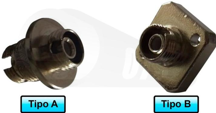
Adaptador FC simplex hembra / hembra, se usa cuando necesitas enfrentar un conector FC en una bandeja o en una caja terminal de fibra óptica por medio de fijación de tuerca (TIPO A), fijación atornillada (TIPO B). Están fabricados en metal dando precisión al momento de centrar los núcleos de las fibras y el ajuste del conector.
