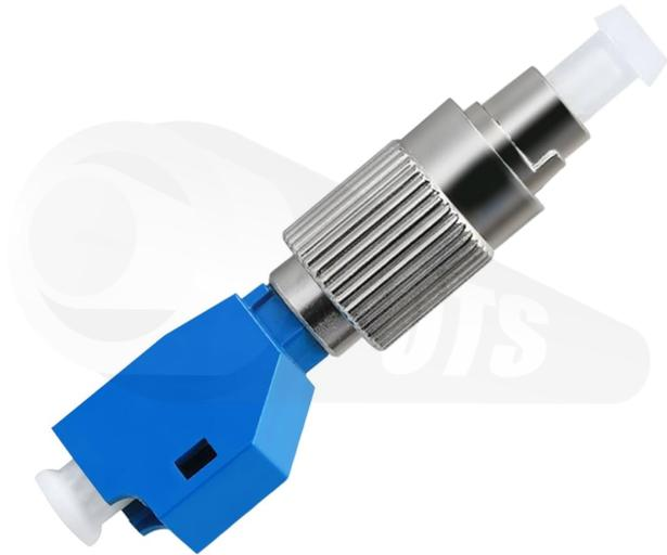
Adaptador con entrada FC Macho y LC Hembra simplex monomodo se usa cuando necesitas cambiar un conector LC a un conector FC sin la necesidad de modificar el patch cord. Están fabricados en plástico de alta resistencia y metal dando precisión al momento de centrar los núcleos de las fibras y el ajuste del conector.
