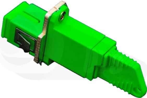
Adaptador con entrada SC Hembra y E2000 Hembra simplex monomodo se usa cuando necesitas acoplar o enfrentar férulas de un conector SC con conector E2000 en una bandeja o en una caja terminal de fibra óptica. Están fabricados en plástico de alta resistencia dando precisión al momento de centrar los núcleos de las fibras y el ajuste del conector.
