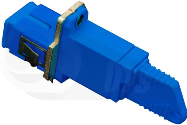
Adaptador con entrada SC Hembra y E2000 Hembra simplex monomodo se usa cuando necesitas acoplar o enfrenar férulas de un conector SC con conector E2000 en una bandeja o en una caja terminal de fibra óptica. Están fabricados en plástico de alta resistencia dando precisión al momento de centrar los núcleos de las fibras y el ajuste del conector.
