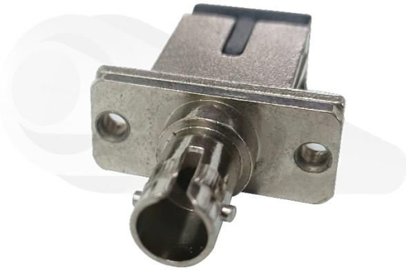
Adaptador con entrada SC Hembra y ST Hembra simplex monomodo se usa cuando necesitas acoplar o enfrenar férulas de un conector SC con conector ST en una bandeja o en una caja terminal de fibra óptica. Están fabricados de metal dando precisión al momento de centrar los núcleos de las fibras y el ajuste del conector.
