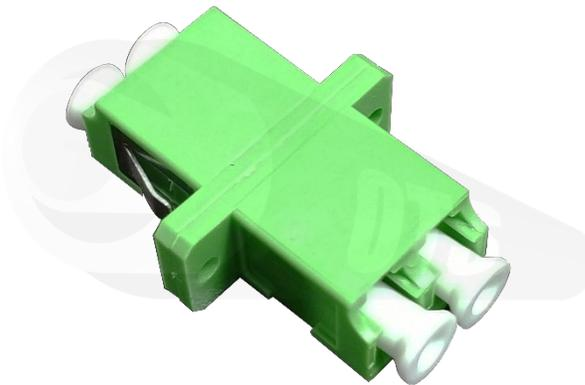
Adaptador LC (APC) dúplex monomodo se usa cuando necesitas acoplar o enfrentar dos férulas anguladas, en una bandeja o en una caja terminal de fibra óptica. Están fabricados en plástico de alta resistencia dando precisión al momento de centrar los núcleos de las fibras y el ajuste del conector.
