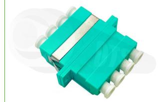
Adaptador LC cuádruplex multimodo se usa cuando necesitas acoplar o enfrentar dos férulas o conectores LC simplex y dúplex en una bandeja o en una caja terminal de fibra óptica. Están fabricados en plástico de alta resistencia dando precisión al momento de centrar los núcleos de las fibras y el ajuste del conector.
