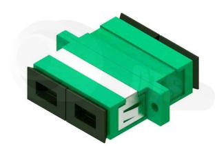
Adaptador SC dúplex monomodo se usa cuando necesitas acoplar o enfrentar dos férulas de conectores SC (APC) en una bandeja o en una caja terminal de fibra óptica. Están fabricados en plástico de alta resistencia dando precisión al momento de centrar los núcleos de las fibras y el ajuste del conector.
