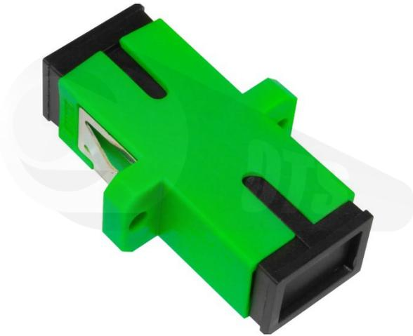
Adaptador con entrada SC simplex monomodo se usa cuando necesitas acoplar o enfrentar férulas de un conector SC en una bandeja o en una caja terminal de fibra óptica. Están fabricados en plástico de alta resistencia dando precisión al momento de centrar los núcleos de las fibras y el ajuste del conector.
