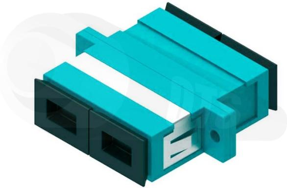
Adaptador SC dúplex multimodo se usa cuando necesitas acoplar o enfrentar dos férulas de conectores SC en una bandeja o en una caja terminal de fibra óptica. Están fabricados en plástico de alta resistencia dando precisión al momento de centrar los núcleos de las fibras y el ajuste del conector.
