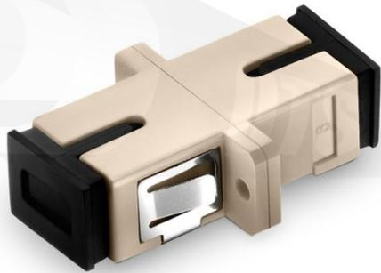
Adaptador con entrada SC simplex multimodo se usa cuando necesitas acoplar o enfrentar férulas de un conector SC en una bandeja o en una caja terminal de fibra óptica. Están fabricados en plástico de alta resistencia dando precisión al momento de centrar los núcleos de las fibras y el ajuste del conector.
