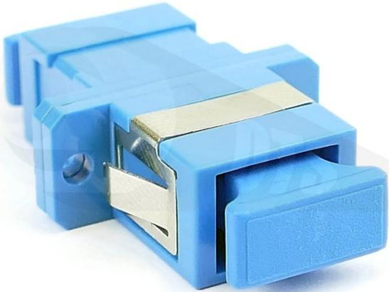
Adaptador con entrada SC simplex monomodo se usa cuando necesitas acoplar o enfrentar férulas de un conector SC en una bandeja o en una caja terminal de fibra óptica. Están fabricados en plástico de alta resistencia dando precisión al momento de centrar los núcleos de las fibras y el ajuste del conector.
