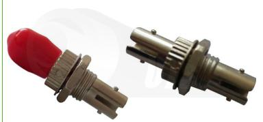
Adaptador con entrada ST simplex monomodo se usa cuando necesitas acoplar o enfrentar férulas de un conector ST en una bandeja o en una caja terminal de fibra óptica. Están fabricados en metal dando precisión al momento de centrar los núcleos de las fibras y el ajuste del conector.
