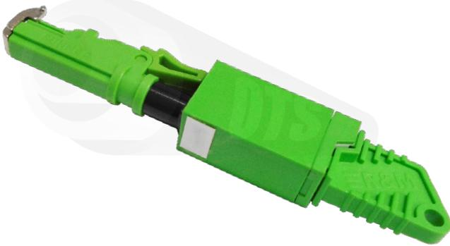
Los atenuadores son dispositivos pasivos, lo cuales ayudan en la comunicación de la fibra óptica con los equipos reduciendo la potencia de la señal. Los atenuadores fijos que distribuimos son hembra a macho en conector E2000 con pulido APC. Las medidas de atenuación van desde 1dB hasta 15dB.
