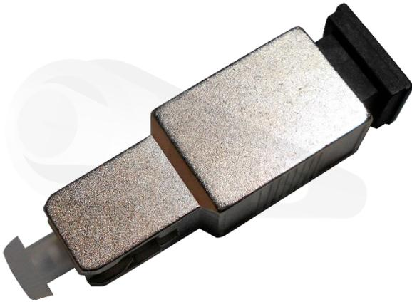
Los atenuadores son dispositivos pasivos, lo cuales ayudan en la comunicación de la fibra óptica con los equipos reduciendo la potencia de la señal. Los atenuadores fijos que distribuimos son hembra a macho en conector SC. Las medidas de atenuación van desde 1dB hasta 15dB.
