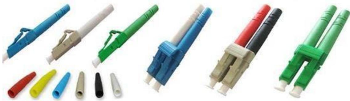
El conector LC OPTICOAX° está diseñado para reducir el espacio en las bandejas y ODF's hasta en un 50%. Utiliza una férula de 1,25 mm, está disponible para fibras Monomodo, para pulidos PC, UPC, APC y Multimodo para pulidos PC y UPC. Los conectores vienen con botas estándar adecuadas para cubiertas con diámetro de 900 $\mu$ m, 2 mm y 3 mm. (El conector con la bota para cada diámetro tienen diferente número de parte). El conector está disponible en dúplex y simplex en colores azul, verde y beige.
