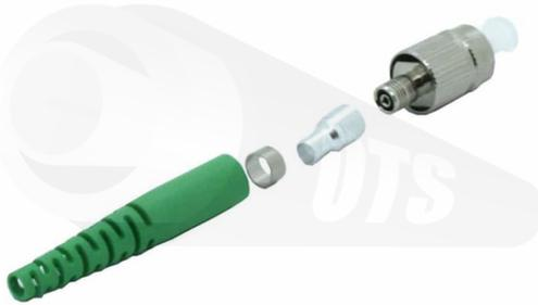
El conector FC (APC) OTS, Utiliza una férula de 2.5 mm, está disponible para fibras Monomodo, para pulidos APC. Los conectores vienen con botas estándar adecuadas para cubiertas con diámetro de 900µm, 2 mm y 3 mm. (El conector con la bota para cada diámetro tienen diferente número de parte). El conector está disponible en simplex en colores metálico.
