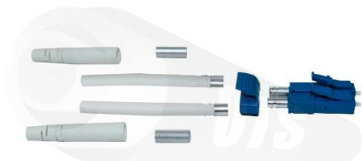
El conector Duplex LC (UPC) OTS, Utiliza una férula de 1.25 mm, está disponible para fibras Monomodo, para pulidos UPC. Los conectores vienen con botas estándar adecuadas para cubiertas con diámetro de 2 mm y 3 mm. (El conector con la bota para cada diámetro tienen diferente número de parte). El conector está disponible en duplex en colores azul.
