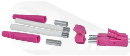
El conector LC (UPC) OTS, Utiliza una férula de 1.25 mm, está disponible para fibras Multimodo OM4, para pulidos UPC. Los conectores vienen con botas estándar adecuadas para cubiertas con diámetro de 2 mm y 3 mm. (El conector con la bota para cada diámetro tienen diferente número de parte). El conector está disponible en duplex en colores morado.
