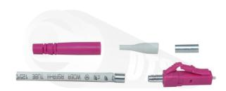
El conector LC (UPC) OTS, Utiliza una férula de 1.25 mm, está disponible para fibras Multimodo OM4, para pulidos UPC. Los conectores vienen con botas estándar adecuadas para cubiertas con diámetro de 900µm, 2 mm y 3 mm. (El conector con la bota para cada diámetro tienen diferente número de parte). El conector está disponible en simplex en colores morado.
