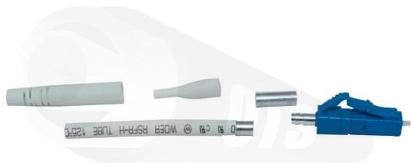
El conector LC (UPC) OTS, Utiliza una férula de 1.25 mm, está disponible para fibras Monomodo, para pulidos UPC. Los conectores vienen con botas estándar adecuadas para cubiertas con diámetro de 900µm, 2 mm y 3 mm. (El conector con la bota para cada diámetro tienen diferente número de parte). El conector está disponible en simplex en colores azul.
