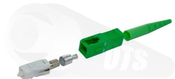
El conector SC (APC) OTS, Utiliza una férula de 2.5 mm, está disponible para fibras Monomodo, para pulidos APC. Los conectores vienen con botas estándar adecuadas para cubiertas con diámetro de 900µm, 2 mm y 3 mm. (El conector con la bota para cada diámetro tienen diferente número de parte). El conector está disponible en simplex en colores verde.
