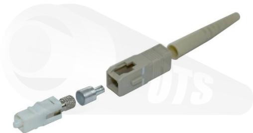
El conector SC (UPC) OTS, Utiliza una férula de 2.5 mm, está disponible para fibras Multimodo OM1 u OM2, para pulidos UPC. Los conectores vienen con botas estándar adecuadas para cubiertas con diámetro de 900µm, 2 mm y 3 mm. (El conector con la bota para cada diámetro tienen diferente número de parte). El conector está disponible en simplex en colores beige.
