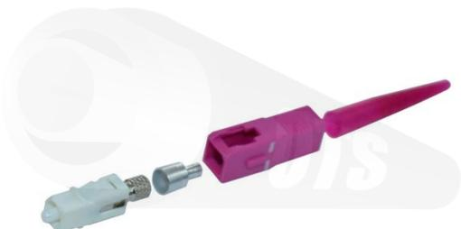
El conector SC (UPC) OTS, Utiliza una férula de 2.5 mm, está disponible para fibras Multimodo OM4, para pulidos UPC. Los conectores vienen con botas estándar adecuadas para cubiertas con diámetro de 900µm, 2 mm y 3 mm. (El conector con la bota para cada diámetro tienen diferente número de parte). El conector está disponible en simplex en colores morado.
