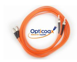
Los patch cord OPTICOAX de fibra óptica multimodo en fibras 50/125 OM2 de 1 Gigabit Ethernet, Fast Ethernet y Ethernet. Los Patch cord multimodo se fabrican utilizando cables en chaqueta PVC, LSZH, OFNR y PLENUM de acuerdo con la necesidad del proyecto y se ajusten a las normas IEC, EIA TIA y Telcordia. Los cables de conexión OM2 se terminan con conector estándar FC y ST multimodo que le dan un rendimiento óptimo.
