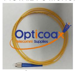
Los pigtail OPTICOAX de fibra óptica monomodo en diámetros internos de 9/125, Diámetro de chaqueta en 900 µm, 2mm y 3mm fabricadas en PVC o LSZH, de acuerdo con la necesidad del proyecto, se ajusten a las normas IEC, EIA TIA y Telcordia. Los pigtail se realizan con conector estándar FC.
