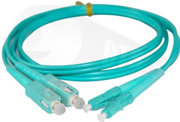
Los patch cord OTS de fibra óptica multimodo en fibras 50/125 OM3 optimizados para conectar redes de alta velocidad de 10 Gigabit Ethernet. Los Patch cord multimodo se fabrican utilizando cables en chaqueta PVC o LSZH que se ajusten a las normas IEC, EIA TIA y Telcordia. Los cables de conexión OM3 se terminan con conector estándar LC y SC multimodo que le dan un rendimiento óptimo.
