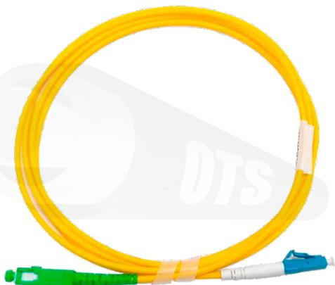
Los patch cord OTS de fibra óptica monomodo con diámetro interno 9/125. se fabrican utilizando cables en chaqueta PVC, se ajusten a las normas IEC, EIA/TIA y Telcordia. Los cables de conexión terminan con conector estándar LC y SC (APC) monomodo cerámicos que le dan un rendimiento óptimo.
